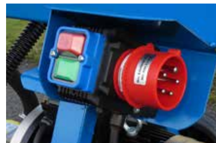
Motorskydd med fasväxlare 3-fas 400 V
