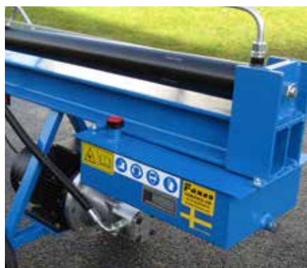
Separat oljetank baktill ELH1100
